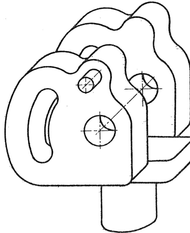
Kosa projekcija se koristi kada na čeonj površini ima veliki broj kružnica, pa se crtaju kružnice i kružni lukovi, a ne elipse i eliptični lukovi.
