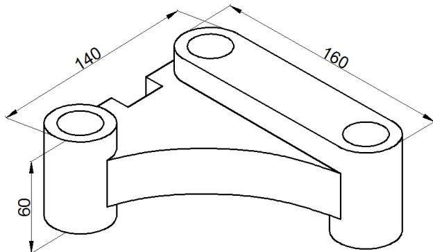
Zadati predmet prikazati na hamer papiru formata A3 u tri projekcije i standardnoj razmjeri (1:1). Predmet mora biti u odnosu na oblik i dimenzije u potpunosti definisan. Dimenzije predmeta usvojiti tako da gabaritne mjere i oblik predmeta ne budu narušeni.
