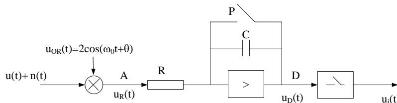
Odabiranje signala obavlja se na kraju svakog signalizacionog intervala, a pomoću prekidača  $P$  vrši se trenutno rasterećenje kondenzatora  $C$  na početku svakog signalizacionog intervala.
