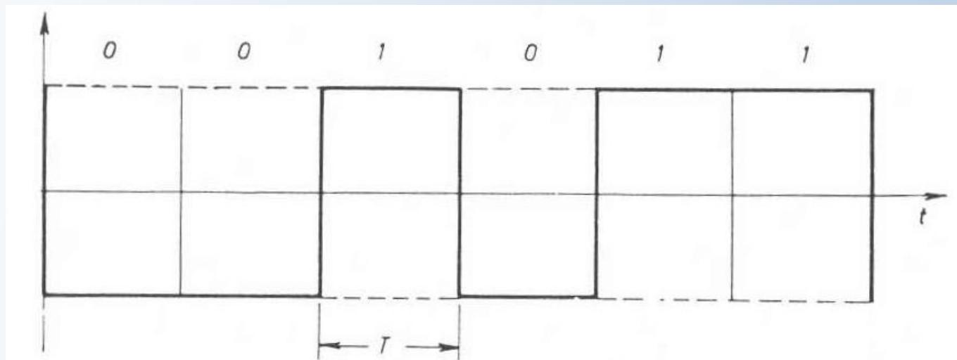
Ako bi ovakav signal doveli na ulaz osciloskopa čija je vremenska baza podešena trajanju jednog signalizacionog intervala  $T$ , onda bi se na njegovom ekranu dobio dijagram kao na slici desno. To su dvije deblje izvučene horizontalne linije nastale preklapanjem elemenata signala iz svih signalizacionih intervala.
