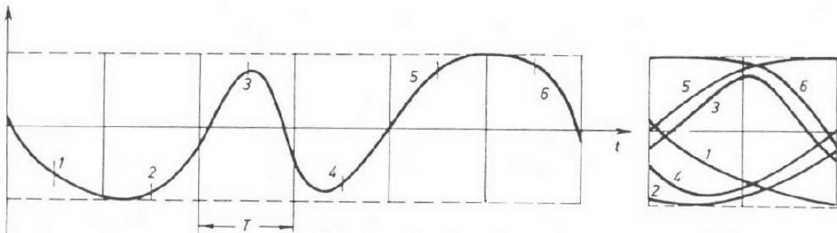
Ovi djelovi signala iz pojedinih signalizacionih intervala koji su preklopljeni jedan preko drugog daju **dijagram oka**. Naravno, ako se uzme duga povorka impulsa, mnoge linije će se preklopiti i obrazovaće se zadebljani tragovi. Oni su prikazani kao osjenčene površine na slici.
