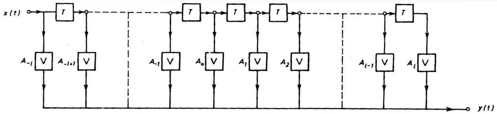
Signal uzet sa svakog izvoda prolazi kroz njemu odgovarajući pojačavač. Pojačanja pojačavača  $A_{-l}, A_{-l+1}, \dots, A_{-1}, A_0, A_1, A_2, \dots, A_l$  mogu da se podešavaju i po svom iznosu i po znaku (pojačanje može biti manje od 1). Izlazni signali iz svih pojačavača se sabiraju i tako daju rezultantni izlazni signal.
