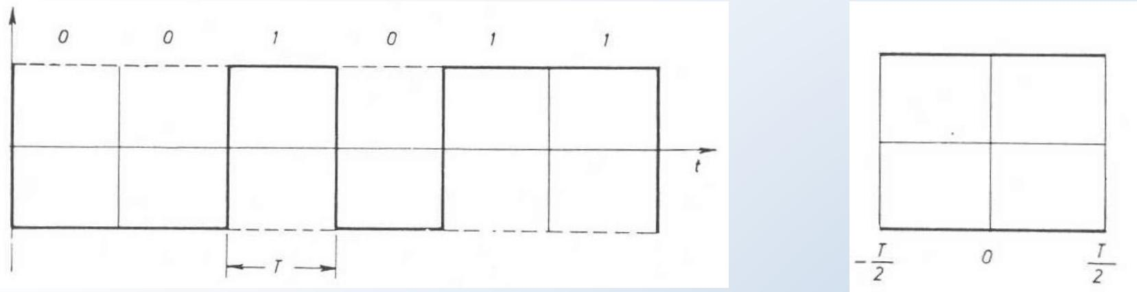
Međutim, na drugoj strani veze primljeni signal je izobličen i može da ima formu kao na slici, pa preklopljeni tragovi ovog signala na ekranu osciloskopa izgledaju drugačije:
