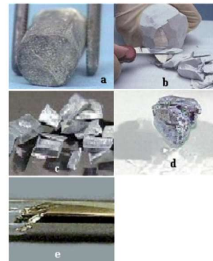
Slika 3.3: Alkalni metali a) litijum, b) natrijum, c) kalijum, d) rubidijum, e) cezijum
