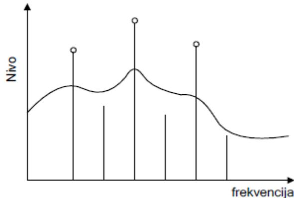
Usljed audio maskiranja prenosimo samo one odbirke koji su iznad krive maskiranja. Stoga je broj bita potreban za prenos tih odbiraka  $3 \cdot 8 = 24$  bita.
