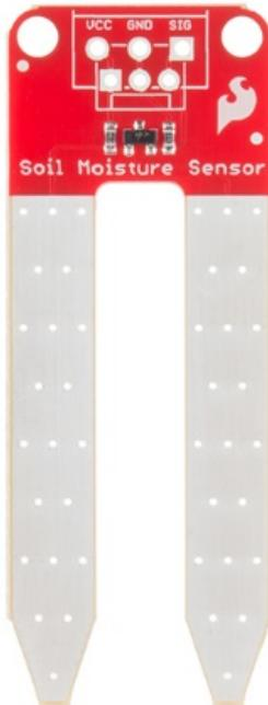
Mjeri vlažnost zemljišta na osnovu promjene električne provodljivosti zemlje (otpornost zemljišta se povećava sa sušom).
