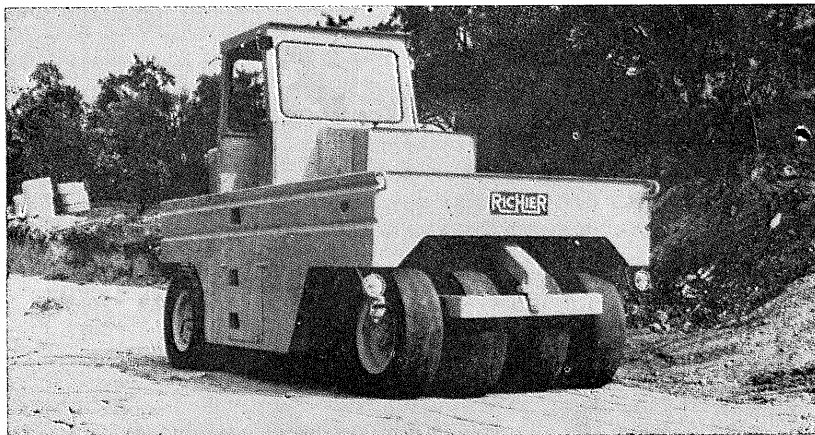
Sl. I.I — Uređaj za zbijanje s gumenim točkovima
