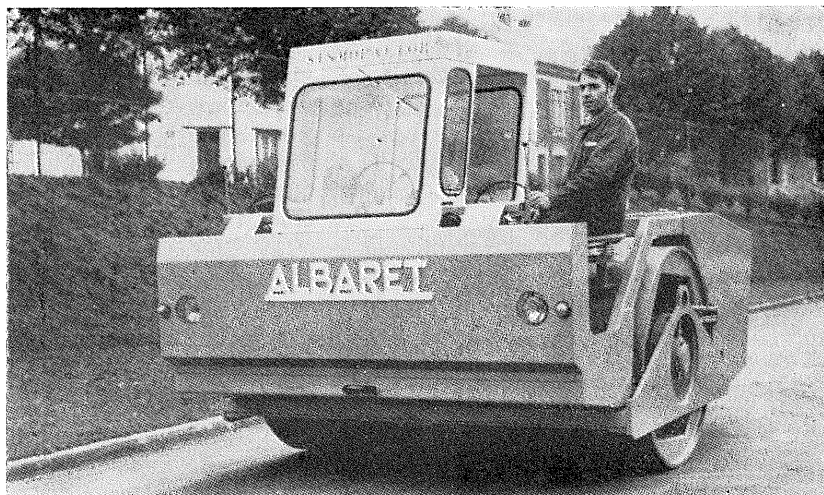
Sl. II.XI — Vibracioni samohodni valjak od 8,7 t. (Foto Albaret)
