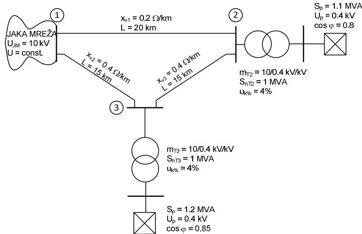
8. Odrediti struje i napone grana mreže dijela elektroenergetskog sistema prikazane na slici koristeći metod napona čvorova. Svi parametri dati su u jediničnim vrijednostima,  $U_R = 4$ .
