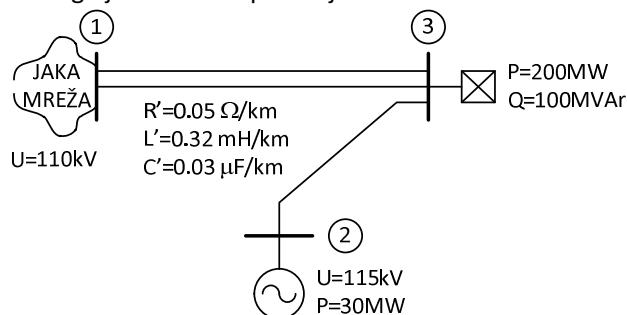
7. Za dio sistema datog na slici potrebno je odrediti napone i struje u granama mreže koristeći matrični metod nezavisnih struja. Potrošače predstaviti konstantnim injektiranjem struje. Odrediti snagu koja se isporučuje potrošačima. Odrediti napon na potrošačkim sabirnicama.
