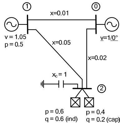
3. Za jednopolno prikazani EES, sa potrebnim veličinama datim na slici, odrediti promjenljive stanja poslije prve iteracije. Koristiti Gauss-Seidel-ov iterativni postupak rješavanja metode napona čvorova.
