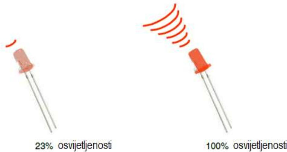
Analogni izlaz može biti simuliran upotrebom impulsno širinske modulacije (PWM)
