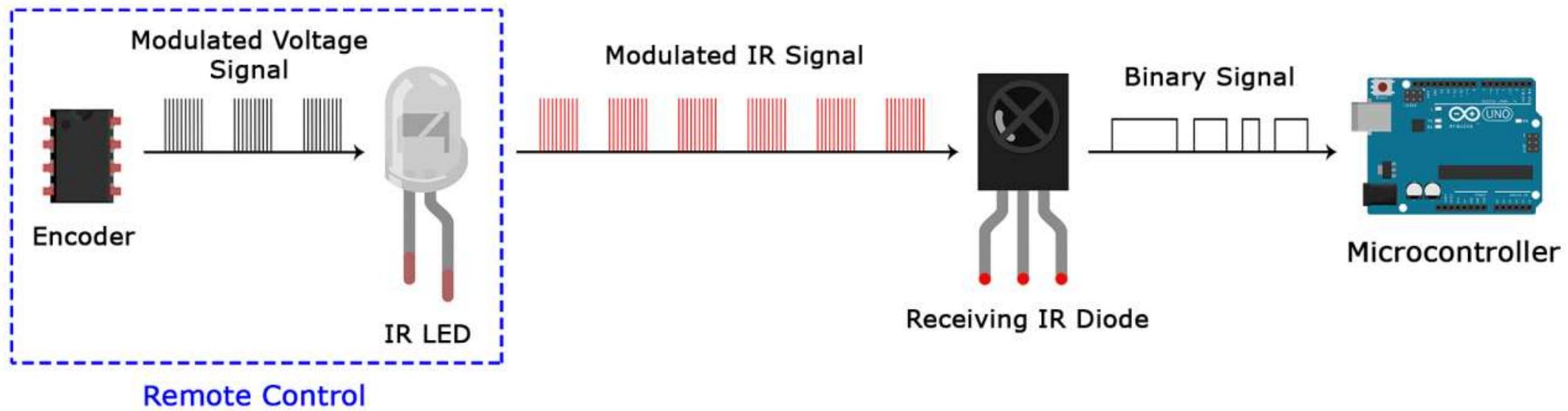
Modulisani IR signal je serija IR svjetlosnih impulsa visoke frekvencije, poznate kao frekvencija nosioca (PCM - Pulse Code Modulation frekvencija).
