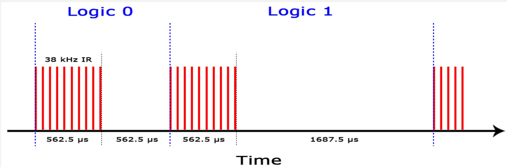
Na ovaj način NEC protokol kodira i dekodira binarne podatke u/iz modulisanog signala.
