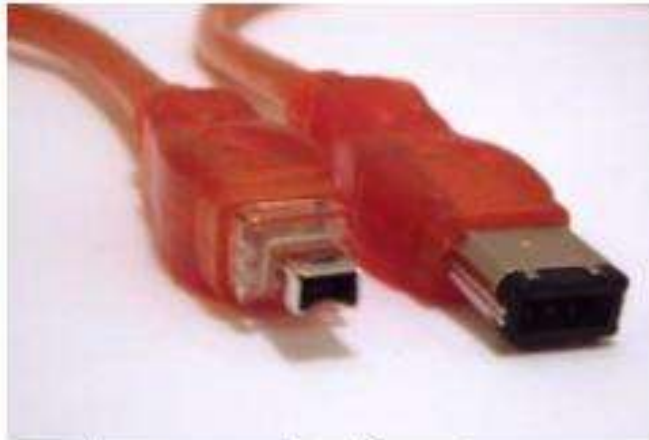
4-pinski (lijevo) i 6-pinski (desno) FireWire konektori
