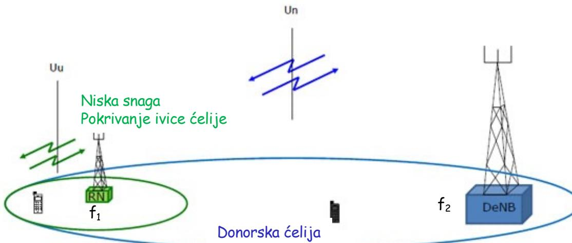
$f_1 = f_2$ , inband, Tip 1 RN - moguća interferencija
