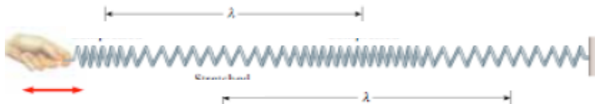
Slika 1. Longitudinalni talas. Čestice osciluju u pravcu kretanja talasa.
