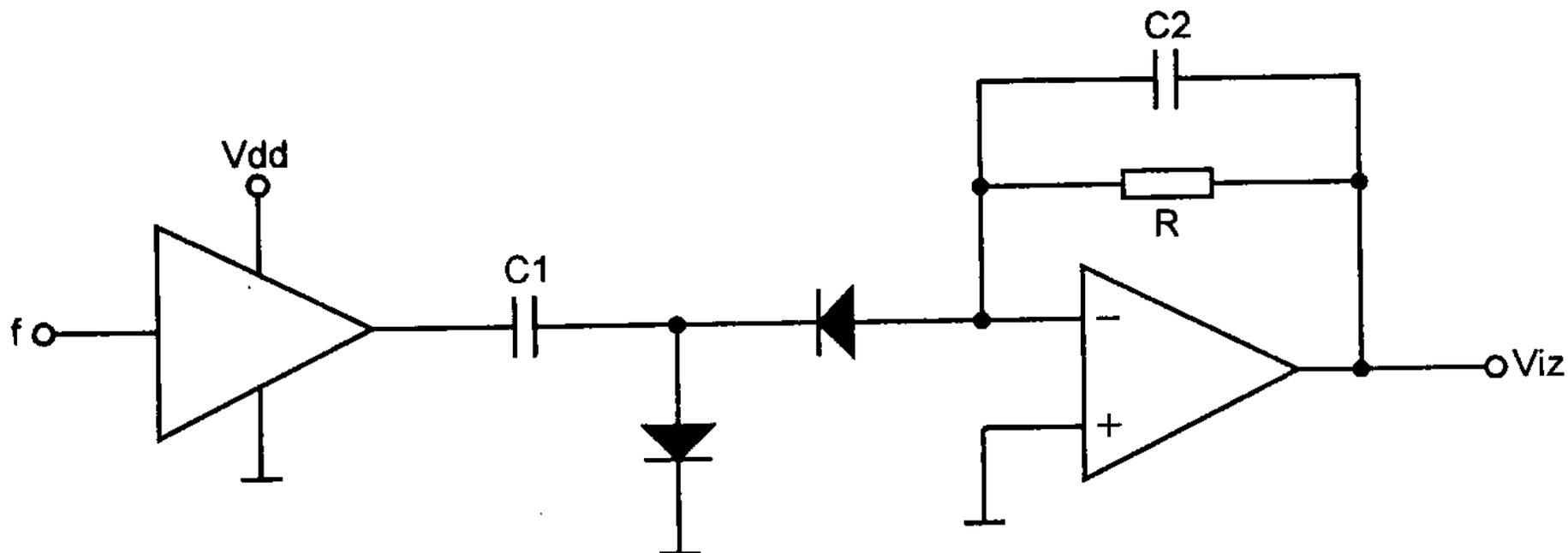
$$V_{iz} = R \cdot C_1 \cdot V_{dd} \cdot f = K \cdot f$$
