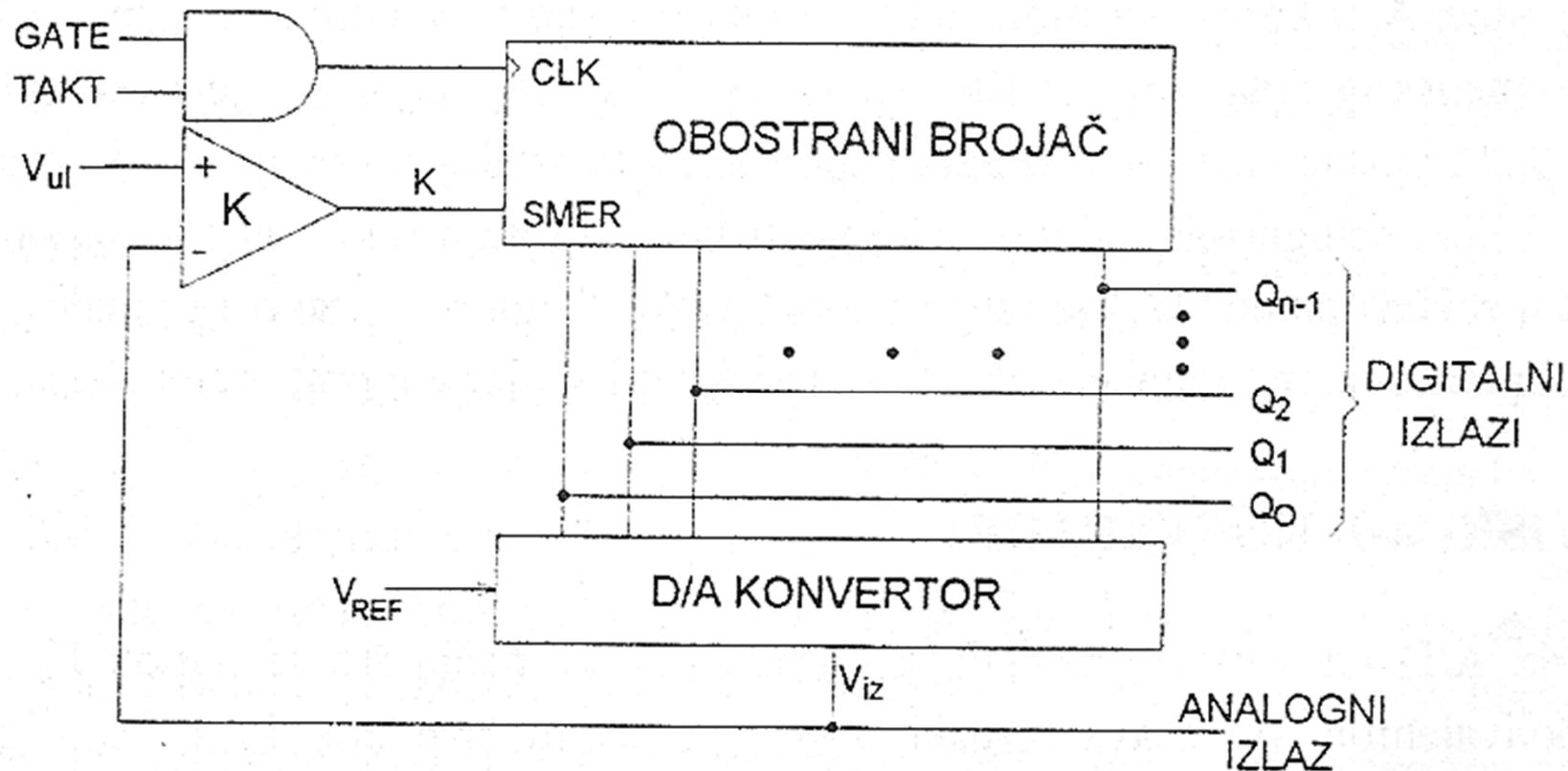
Zavisno od toga da li je ulazni napon veći ili manji od napona postavljenog na D-A konvertoru, komparator komanduje brojaču da broji naviše ili naniže.
