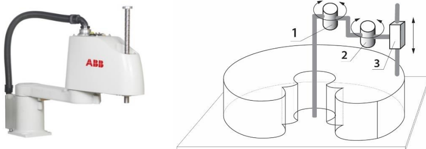
Slika 6 – SCARA robot (levo) i njegova minimalna funkcionalna šema (desno) (preuzeto sa: https://new.abb.com/products/robotics/industrial-robots/irb-910sc ).
