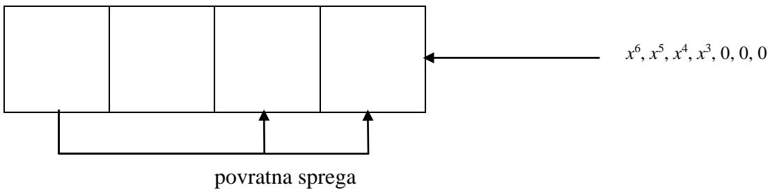
Povratnu spregu možete razumjeti kao operaciju ekskluzivno ili stanja u prvoj ćeliji (prvom flip flop) sa ostalim elementima na koje se odnosi. Da je polinom na osnovu kojeg je kod kreiran bio  $x^3+x^2+1$  povratna sprega bi vodila sa prve na drugu i četvrtu ćeliju.
