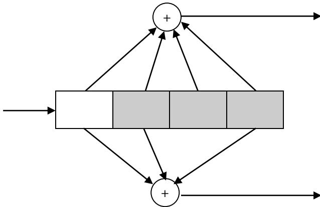
**Napomena.** Ovo je alternativni način da se vizuelizuju koder konvolucionog koda kod kojega smo spojili pojedine ćelije pomjeračkog registra. Bijela ćelija je zapravo ulazni bit dok su osjenčeni bitovi memorija ovog kodera.
