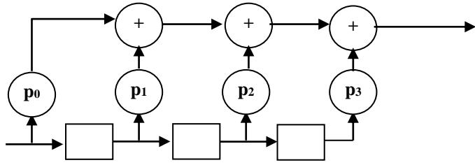
Kolo koje realizuje kodiranje na osnovu prostog polinoma  $x^3+x+1$  je dato na narednoj slici.
