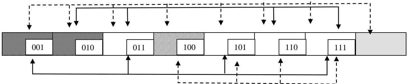
Na slici je grafički ilustrovano što se dešava kod Hammingovog koda (8,4) odnosno koji biti parnosti kontrolišu koje informacione bite. Kao memotehnika može da posluži činjenica da biti parnosti na pravilnim binarnim pozicijama kontrolišu one bite koji imaju u binarnoj predstavi pozicije bita u kodnoj riječi jedinicu na istom mjestu kao i sami biti parnosti. Međutim, uskoro ćemo vidjeti da to ne mora da bude slučaj odnosno da se biti parnosti ne moraju raspoređivati na pravilne binarne pozicije.
