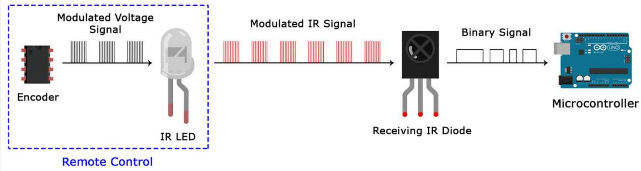
Modulisani IR signal je serija IR svjetlosnih impulsa visoke frekvencije, poznate kao frekvencija nosioca (PCM - Pulse Code Modulation frekvencija).
