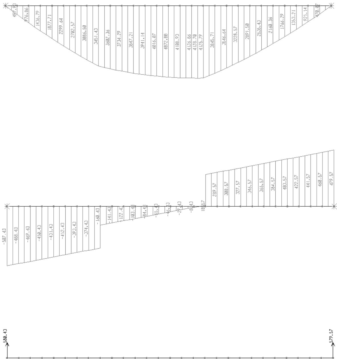
**SAOBRAĆAJNO OPTEREĆENJE – faza spregnutog presjeka – p/2**
