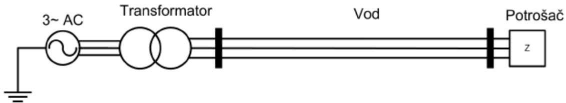
Slika 2. Jednopolna šema dijela elektroenergetskog sistema
