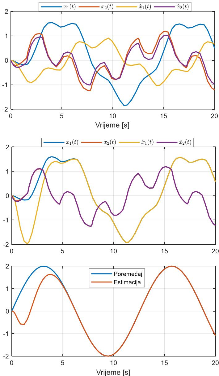
Na prvoj slici lijevo su prikazane estimirane i stvarne vrijednosti promjenljivih stanja u slučaju kada nije implementiran opserver poremećaja. Može su uočiti da postoje značajna odstupanja u estimaciji promjenljivih. Na sljedećoj slici su prikazane promjenljive stanja u slučaju kada postoji DOB (disturbance observer). Može se primijetiti da u ovom slučaju estimirana stanja nakon 5s konvergiraju ka stvarnim vrijednostima. Konačno, na zadnjoj slici je prikazan estimirani poremećaj.
