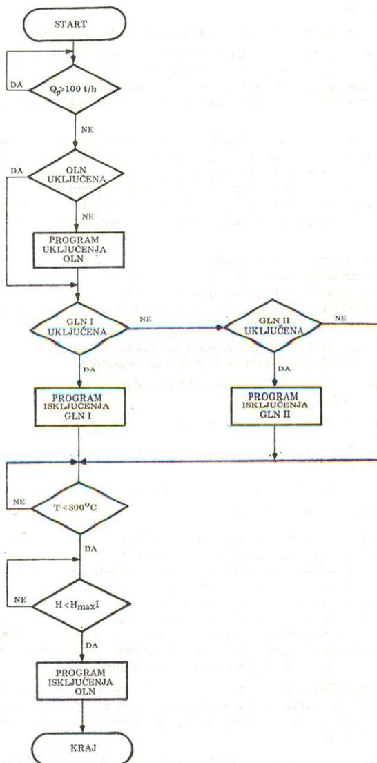
Ukoliko je prilikom uključenja radne GLN došlo do neispunjena neke od komandi (smetnje na izabranoj GLN), automatski se generiše komanda za uključenje rezervne linije, a nakon njenog uključenja komanda za isključenje linije na kojoj je došlo do kvara.
