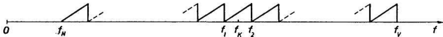
Slika: Šematski prikazani spektri signala u pojedinim kanalima multipleksa sa frekvencijskom raspodelom kanala
