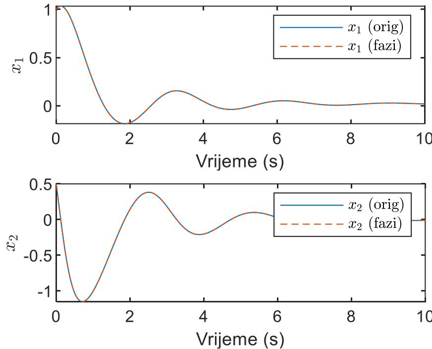
Sa slika iznad se može uočiti da T-S fazi sistem egzaktno aproksimira nelinearni sistem.
