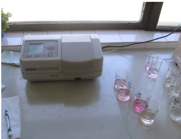
Slika VIS spektrofotometar za određivanje \text{NH}_4^+ , \text{NO}_2^- , \text{NO}_3^- , Fe, Al, \text{SO}_4^{2-} , \text{PO}_4^{3-} , Mn, fenola...
