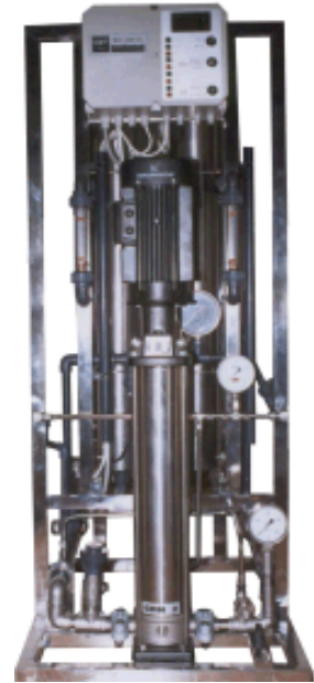
Slika RO Stanica, kapaciteta 400 l/h i RO Blok, kapaciteta 1200 l/h (4 RO Modula)
