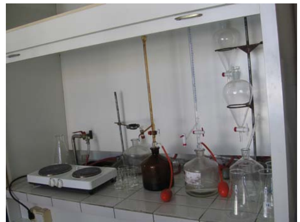
Slika Aparatura za određivanje utroška \text{KMnO}_4 , i pripremu za spektrofotometrijska merenja
