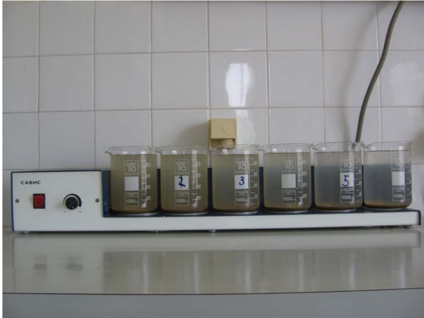
Slika - Eksperimentalna oprema za utvrđivanje JAR testa, Vodovod Raška
