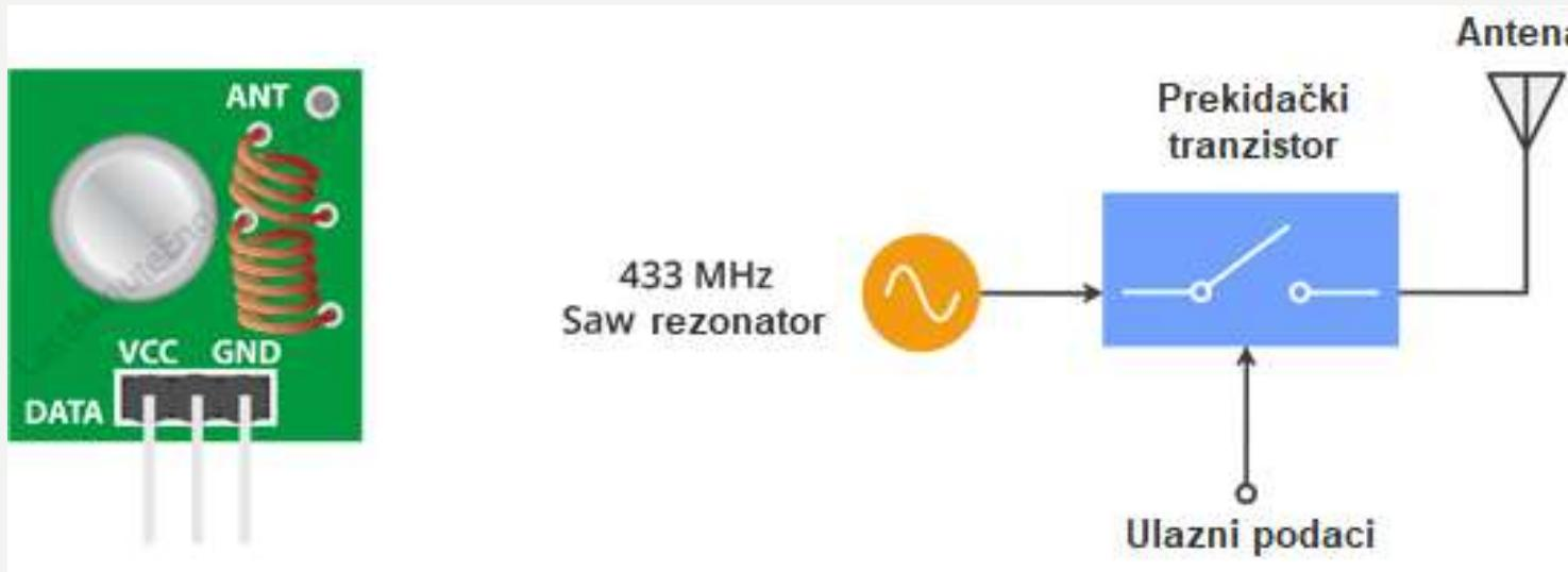
Kada je logičko HIGH na DATA ulazu, oscilator se pokreće i prizvodi konstantni RF nosilac i kada je logičko LOW da DATA ulazu oscilator se zaustavlja.
