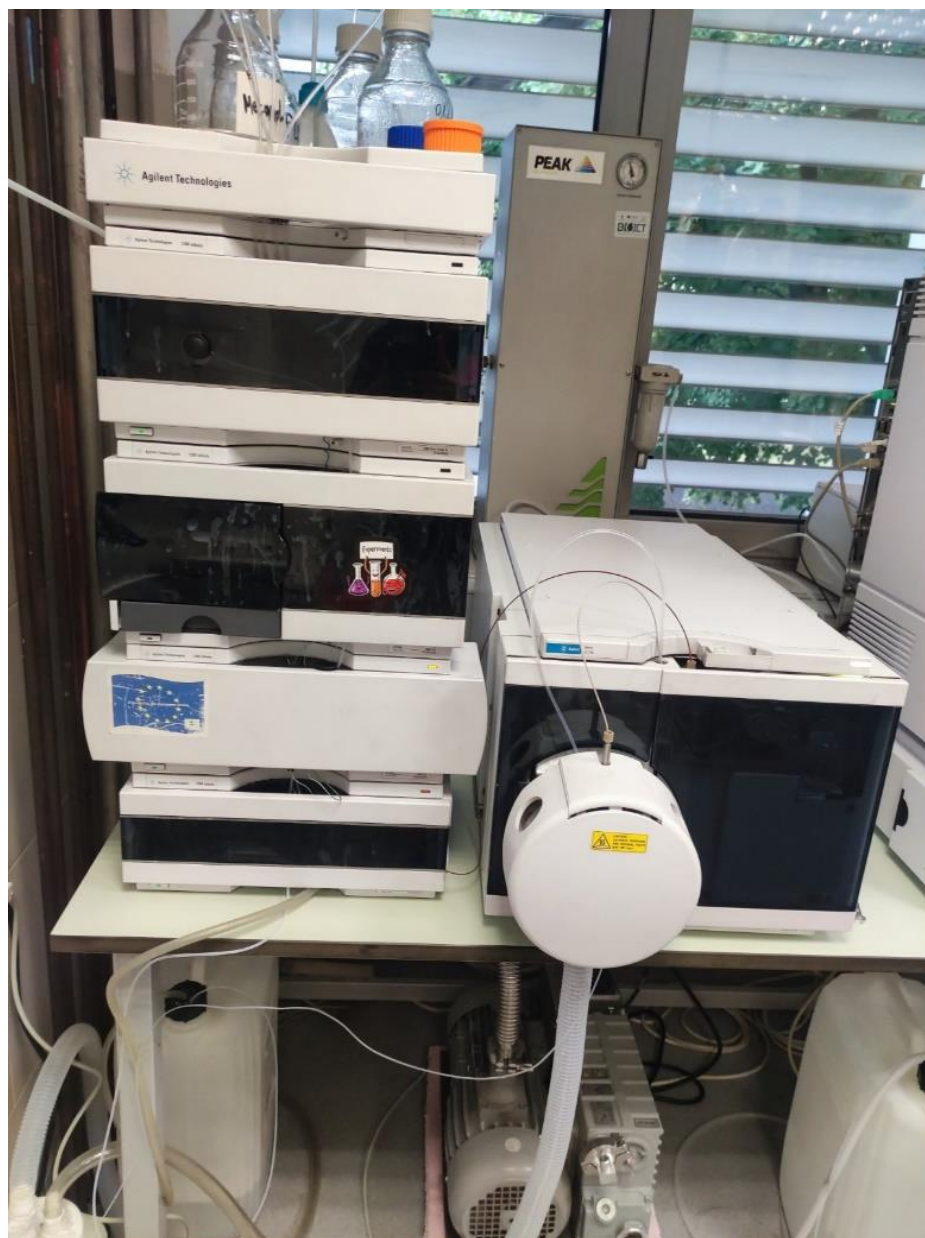
Slika 7. Tečni hromatograf sa Masenim spektrometrom (Agilent 1260 Infinity sa Agilent 6465B masenim detektorom)
