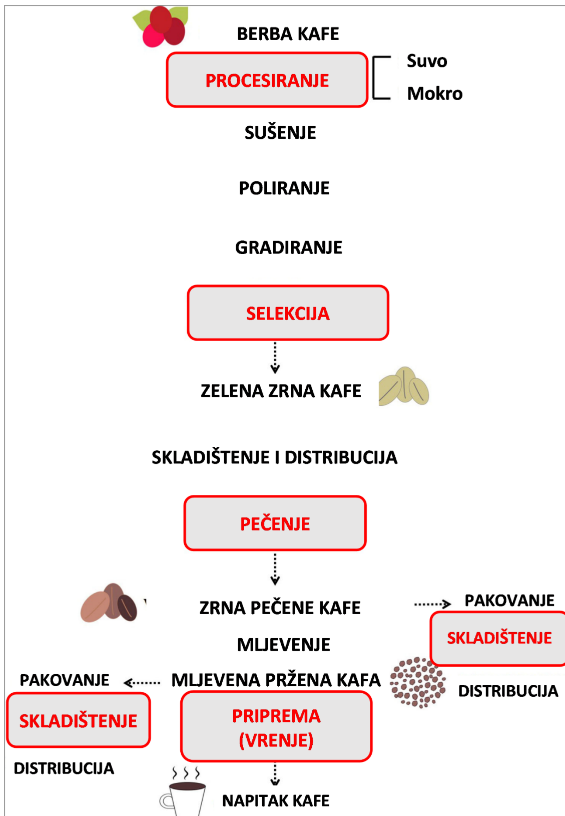
Slika 6. Šematski prikaz procesiranja kafe od berbe do napitka kafe. Stadijumi koji su bitni sa aspekta smanjenja sadržaja akarilamida u kafi su označeni crvenom bojom (prilagođeno iz (Schouten et al. 2020)).
