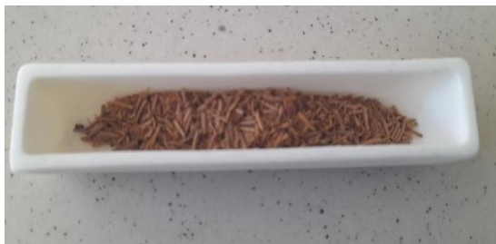
Slika 39. Prikaz sprovođenja postupka pirolize na temperaturi od 400 °C pri protoku azota oko 60 cm 3 min -1
