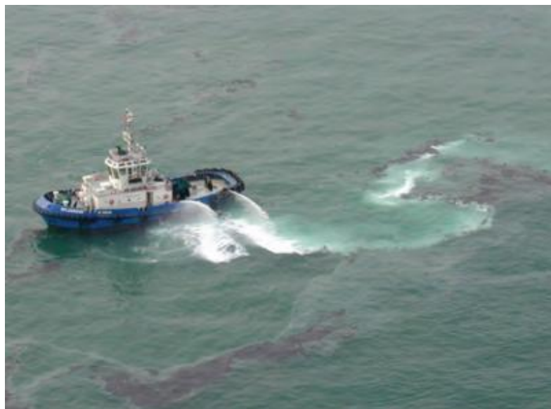
Slika 16. Hemijski metod uklanjanja naftnih zaprljanja – raspršivanje upotrebom disperzanata [25]
