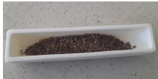
Slika 39. Prikaz sprovođenja postupka pirolize na temperaturi od 400 °C pri protoku azota oko 60 cm 3 min -1
