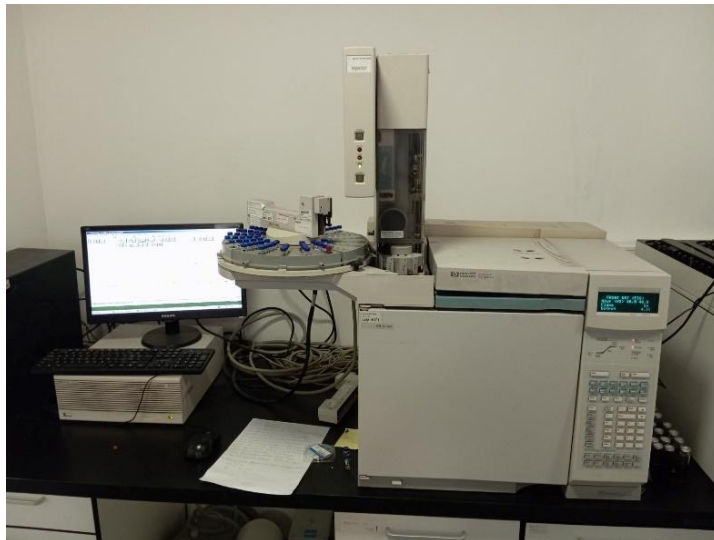
Slika 37. GC-FID HP G1530A - gasni hromatograf sa plameno – jonizujućim detektorom
