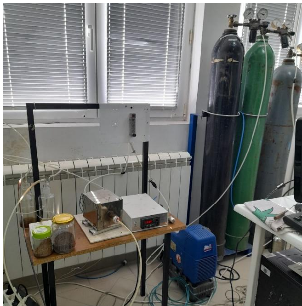
Slika 30. Peć za žarenje/pirolizu sa kontrolom atmosfere
