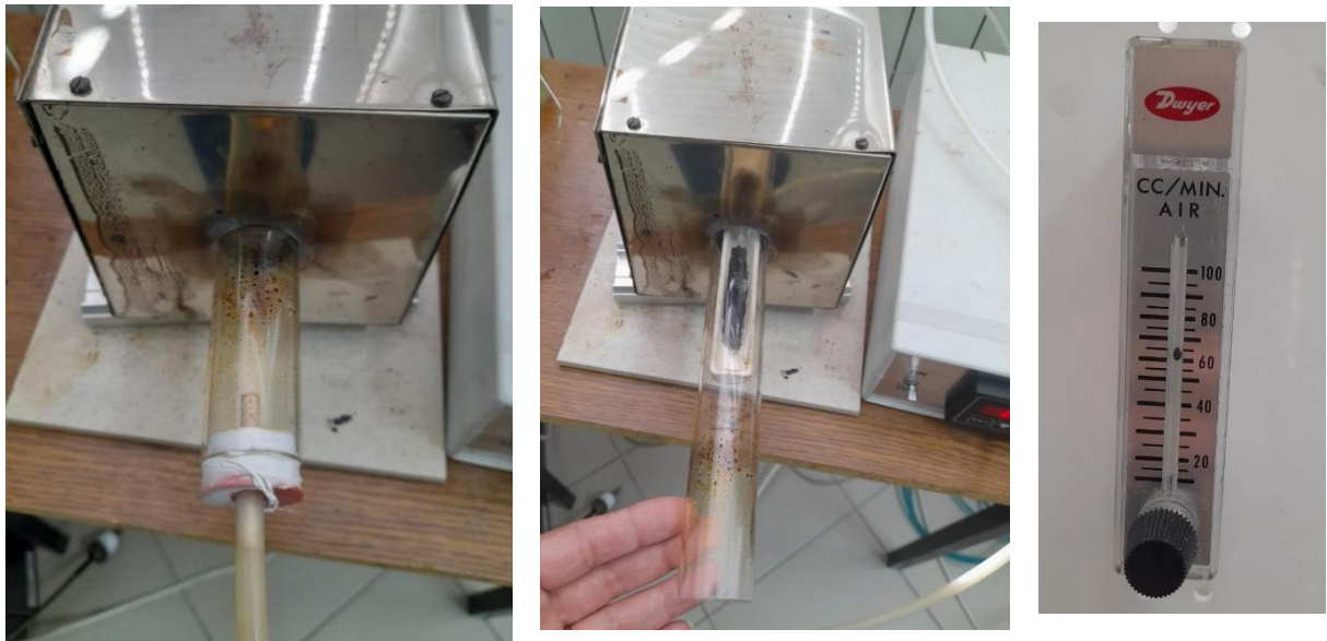
Slika 39. Prikaz sprovođenja postupka pirolize na temperaturi od 400 °C pri protoku azota oko 60 cm 3 min -1
