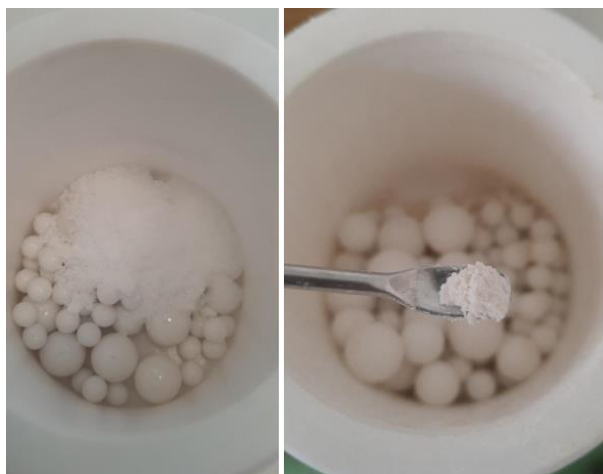
Slika 24. \text{NH}(\text{CH}_2\text{COOH})_2 i (\text{NH}_4)_2\text{CO}_3 prije miješanja (lijevo) i nakon 2 h miješanja (desno)
