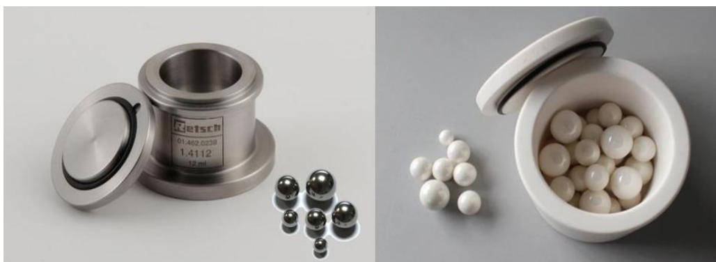
Slika 22. Teglice i kuglice od nerđajućeg čelika (lijevo) i cirkonijum-dioksida (desno)
