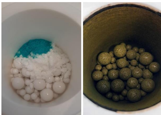
Slika 28. (\text{NH}_4)_3\text{idadtC} i \text{CuCl}_2 \cdot 2\text{H}_2\text{O} prije miješanja (lijevo) i nakon 1 h miješanja (desno)
