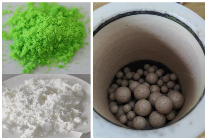
Slika 26. \text{NiCl}_2 \cdot 6\text{H}_2\text{O} i (\text{NH}_4)_3\text{idadt} prije miješanja (lijevo) i \text{K2Ni-idadt} nakon 1 h miješanja (desno)
