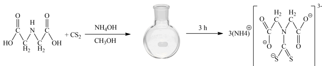
Šema 5. Sinteza liganda (\text{NH}_4)_3\text{idadt} konvencionalnom metodom iz rastvora
