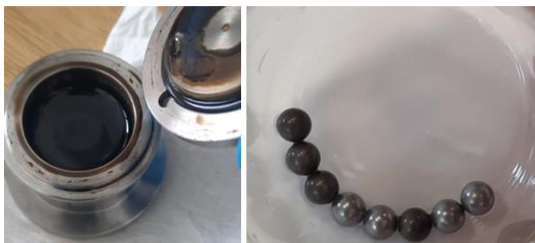
Slika 32. Promjena boje proizvoda K1Ni-idadt (lijevo) i kuglica (desno) uzrokovana skidanjem zaštitnog sloja
