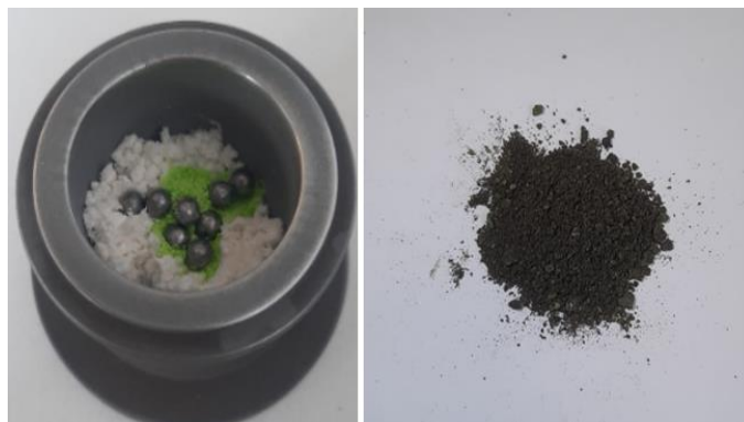
Slika 25. \text{NiCl}_2 \cdot 6\text{H}_2\text{O} i (\text{NH}_4)_3\text{idadt} prije miješanja (lijevo) i \text{K1Ni-idadt} nakon 1 h miješanja (desno)
