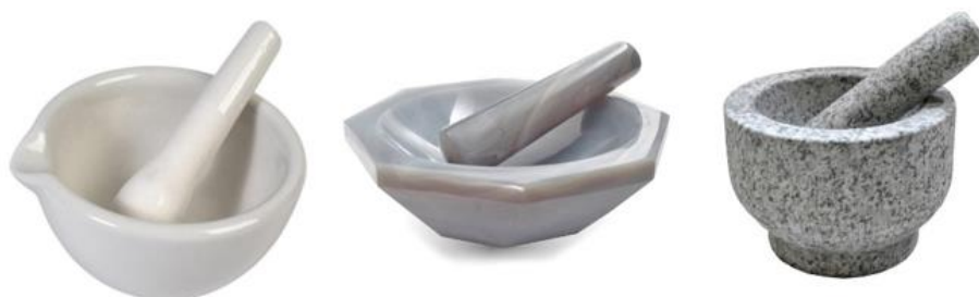
Slika 3. Avani s tučkom napravljeni od različitog materijala (keramika, ahat, granit)
