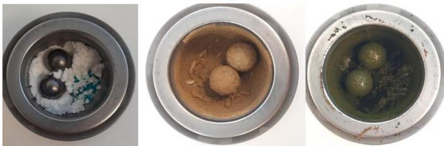
Slika 27. \text{CuCl}_2 \cdot 2\text{H}_2\text{O} i (\text{NH}_4)_3\text{idadtC} prije početka miješanja (lijevo), nakon 15 min (sredina) i nakon 30 min miješanja (desno)
