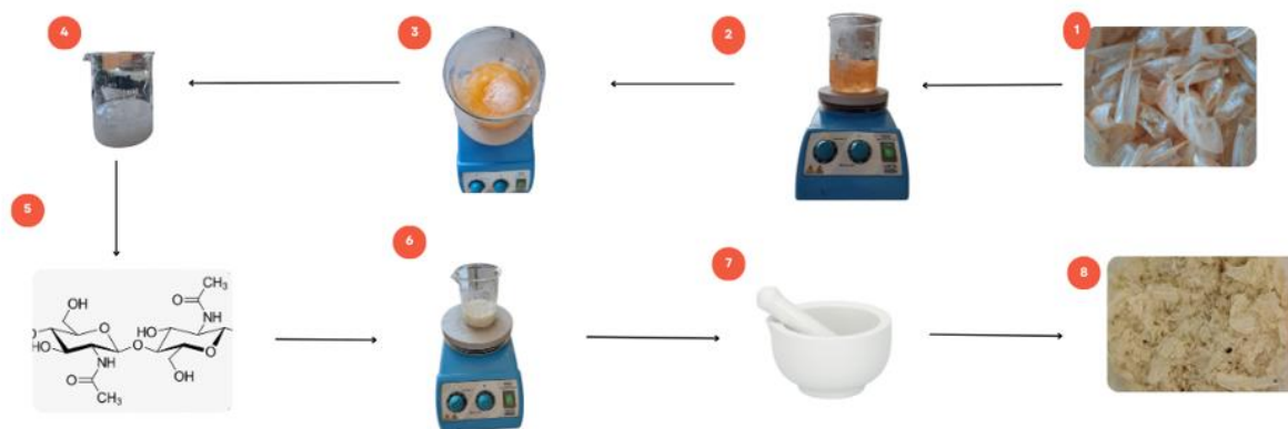
Slika 20. Šema dobijanja hitozana prvim postupkom
