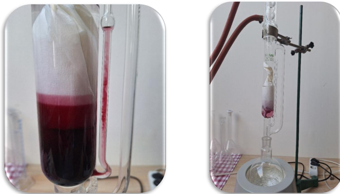
Slika 2. Aparatura za izvođenje Sokslet ekstrakcije (Foto: Blagojević Sanja)
