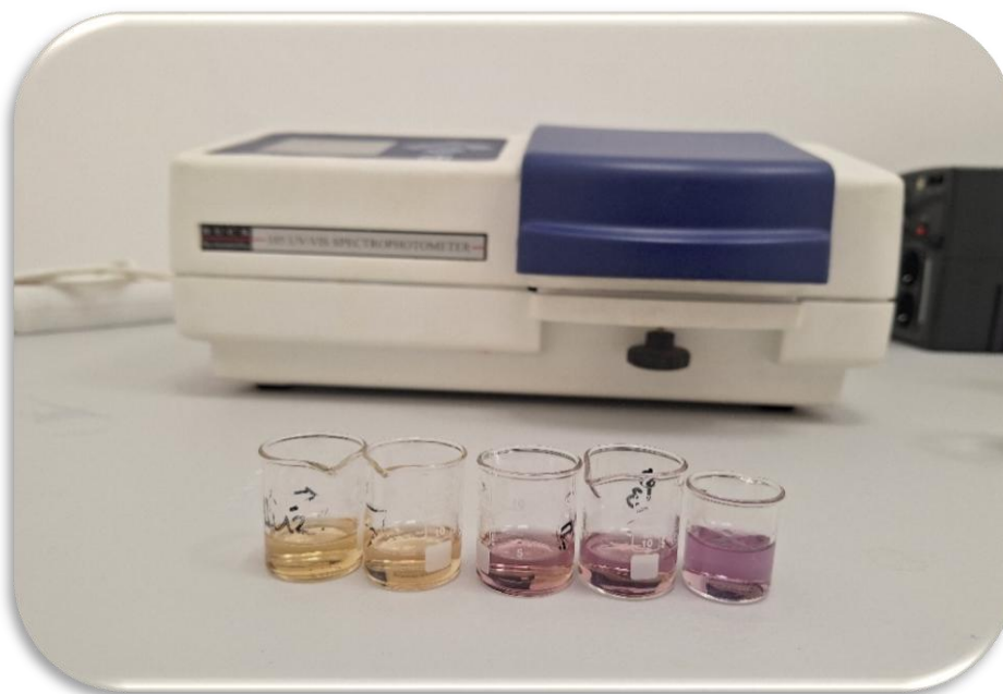
Slika 11. Vizuelna promjena DPPH rastvora usled reakcije sa antioksidantom i UV/VIS spektrofotometar (Foto: Blagojević Sanja)
