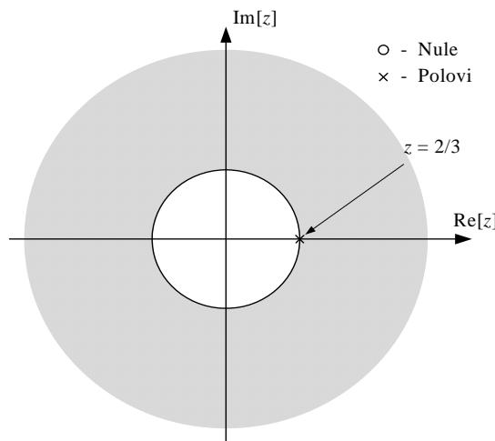
Da bi odredili  $x(n)$  čija je Z-transformacija  $X(z) = \frac{1}{2-3z}$ ,  $X(Z)$  pokušavamo svesti na izraz za izračunavanje sume geometrijskog reda čiji opšti član sadrži  $z^{-1}$ . Jedan od načina da to učinimo je da napišemo izraz za datu Z-transformaciju kao:
