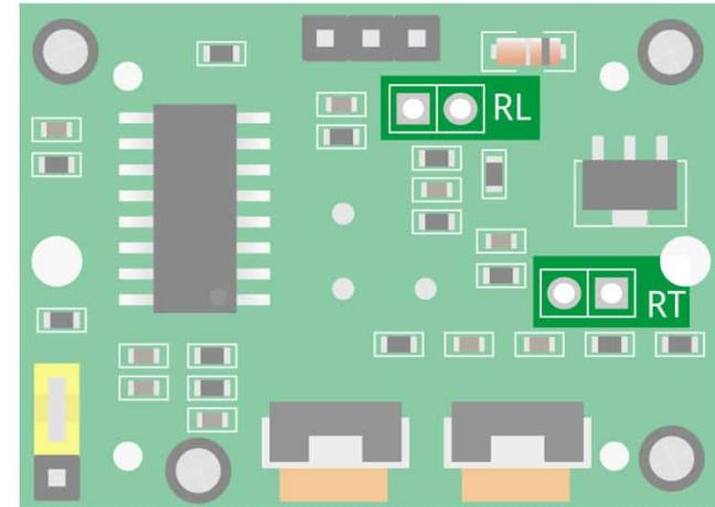
RL – Na ovom mjestu se može dodati light dependent resistor (LDR) ili fotootpornik koji ima nisku otpornost dok je ambijentno svjetlo jako. Time se ograničava da detector funkcioniše samo kada je u prostoru detekcije dovoljno mračno.
