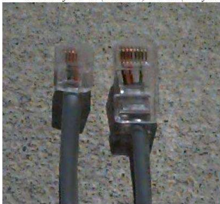
Poređenje RJ45 (Ethernet) i RJ11 (Telefonskog) konektora UTP sa 4 parice
