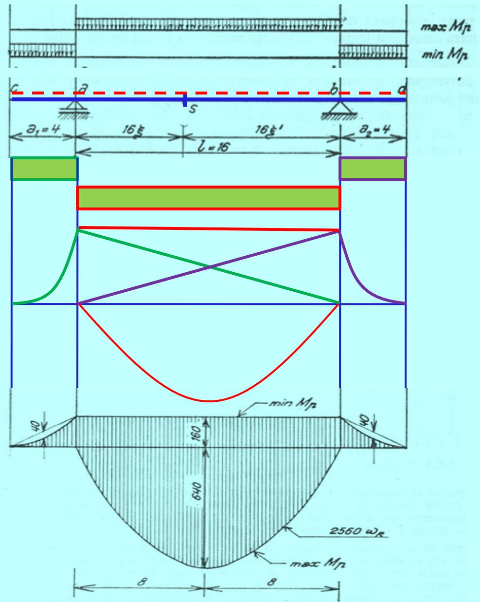
Dijagrami ekstremnih vrijednosti transverzalnih sila, na prepustima jednak je dijagramu transverzalnih sila, a dijagram ekstremnih vrijednosti transverzalnih sila na dijelu ab opisan je izrazima:
