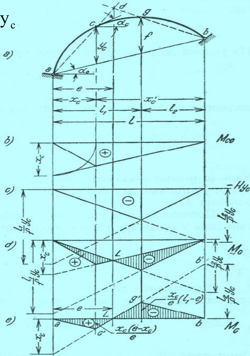
Uticajna linija za momenat savijanja u presjeku c ima nultu tačku L koja se nalazi na vertikali presjeka d pravih a-c i g-b
