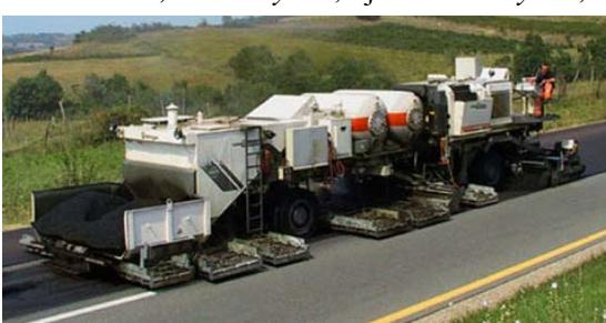
koji “u hodu” istovremeno stružu asfaltni sloj, miješaju ostrugani usitnjeni materijal sa vezivom i ponovo ugrađuju izmješani materijal pomoću više uređaja smještenih ispod pokretnog postolja na gusjenicama. **Obnova asfaltnih zastora moguća je, kao treće, tzv. vrućim postupkom** pomoću **vrlo složenih “remiksera”** (engl. *hot mixer, hot recycler, hot recycling train*, njem. *Heissrecycler, Heissremixer, Heissrecycling Remixe, m.* – slika dolje lijevo←) koji (također “u hodu”)
