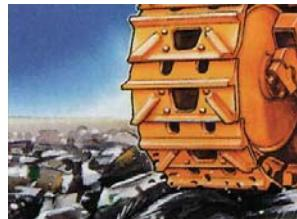
upiranje o tlo prilikom iskopa primjerice kod stajanja bagera. Gusjenice su sklop neke vrste beskrajnog lanca koji se (o)kreće po čeličnim kotačima vodilicama. Na lancu se nalaze učvršćene pločice koje se manjim dijelom međusobno preklapaju. U načelu podvozja strojeva gusjeničara imaju najmanje jedan par gusjenica. Zakretanje stroja se
