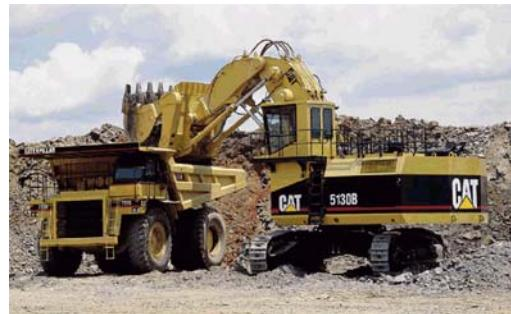
*front shovels*, njem. *Bagger mit Schaufel-Ausrüstung, Schaufelbagger, m.*) u načelu uglavnom rade, dakle kopaju i zatim tovare, od razine svojega stajanja prema gore i od sebe (*slika lijevo* ←). Utovarne lopate mogu biti bez zubiju i sa zubima na donjem bridu sanduka lopate (*slika desno dole* →↓) ovisno u tome da li se rabe samo za utovar ili se rabe za
