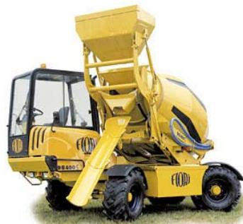
*Gravitacijske mješalice za beton* mogu biti sa čvrstim uspravnim bubenjem (*slika lijevo gore* i *desno dolje*) ili okretnim bubenjem (*slika desno gore*). Primjenjuju se uglavnom za miješanje krupnozrnih betona ili kao male priručne mješalice. Ciklus njihova rada traje do nekoliko minuta. U tvornicama betona koriste se najčeće **prisilne mješalice za beton** koje mješaju sastojke svježega betona u bubenjima pomoću sustava okretnih lopatica.
