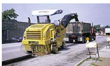
Unutar korita nalazi se rotirajući valjak koji nosi posebno oblikovane šiljke što stružu (glođu) zastor. Korito je tako izvedeno da iza sebe ostavlja izduženu gomilu ostruganog materijala ili se materijal preko transportne trake puni u vozila ispred glodalice. Samo struganje asfalta može biti hladno ili vruće a što znači da glodalica izvodi prethodno zagrijavanje asfaltnog zastora. →**detaljnije vidi** <http://www.bitelli.com/>; <http://www.dynapac.com>; <http://www.wirtgen-group.com>
