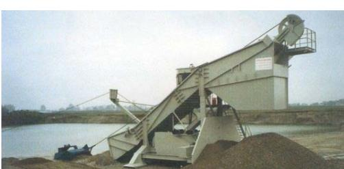
**sajlaša** za iskop kamenih aluvijalnih materijala iz vode s kopna pomoću jedne povlačne košare (→**skrejper**) koja se zabacuje i vuče pomoću posebne opreme u obliku žičare. Kabel-bager obuhvaća, uz ostalo, opremu s druge strane vode (tornjevi, koloture itd.) koja drži i vodi užad sa opremom za iskop što preko kolotura putuje po njoj. Može biti opremljen sa zatvorenom ili otvorenom povlačnom košarom. →detaljnije vidi <http://www.stichweh.de>
