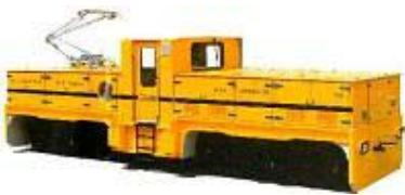
**akulokomotiva** (engl. *battery locomotive*, njem. *Akku-Lokomotive, f.*), vuča transportnih sredstava na tračnicama (primjerice vagona, vagon-mješalica za beton, postolja tehnološke opreme itd.) koja se najčešće primjenjuje u tunelogradnji te ponegdje u proizvodnji gradiva odnosno građevinskih elemenata i sklopova. Akulokomotivu pokreće električna struja iz akumulatora koje nosi na sebi. Masa akumulatora omogućava također povećanje vučne sile akulokomotive. Uglavnom nosi jedan do
