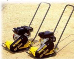
manjih količina zemljanih i sitnijih kamenih materijala u skućenim prostorima. Dijele se na **skakavce ili žabe** (engl. *vibratory tampers, njem. Schnellschlagstampfer, Explosionstampfer, m.* – slika lijevo→) koji nabijanje izvode sporijim ili bržim udarima, te na **vibroploče** (engl. *vibrating plate, njem. Vibrationsplatten, f.* – slika desno←) koje zbijanje izvode vibracijom. Prvi se ne kreću, a pridržavaju se ručno prilikom skakutanja
