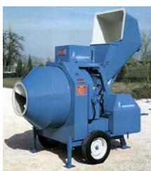
obilježja →**tvornicama betona ili betonarama**). U smislu načina miješanja sastojaka betona rade ili slobodnim padom: **gravitacijske mješalice za beton** (engl. *free-fall concrete mixer*, njem. *Freifallbetonmischer, m.*- *slike lijevo*← i *desno gore*→↑ te *desno*→↓) ili prisilnim putem pomoću okretnih lopatica: **prisilne mješalice za beton** (engl. *forced-action mixer*, njem. *Zwangsmischer, m.* – *slike dolje*↓).
