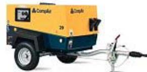
po čovjeka i okoliš opasnu buku. *Pokretni kompresori* sastavna su oprema uz bušaće čekiće i bušilice koje se pogone na stlačeni zrak. Ako su na posebnom podvozju s gumenim kotačima, onda ih neko vozilo ili bušilica vuku sa sobom. →detaljnije vidi <http://www.compair.com> te ostale web-adrese pri bušilicima, bušaćim čekićima i bušaćem priboru
