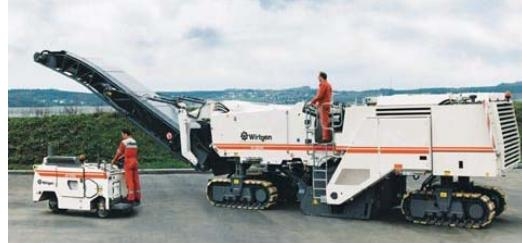
**glodalica, “freza”** (engl. *milling machine*, njem. *Fräsegerät, n.*), samohodni građevinski stroj za struganje posebice asfaltbetonskih zastora cestovnih prometnica, pista i sličnih plošnih građevinskih konstrukcija. Glodalica je najčešće na podvozju sa →**gusjenicama** (*slika desno*→) rijed s gumenim kotačima (*slika lijevo*↔). Na podvozju je ovješeno prema dolje otvoreno korito.
