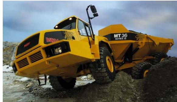
Podvozje sanduka ovih dampera zglobno je vezano s prednjim podvozjem koje nosi motor i kabinu vozača. Mogu biti sa dvije osovine sa kotačima (jedna naprijed ispod motora i kabine te jedna straga ispod sanduka) ili tri osovine sa kotačima (jedna naprijed
