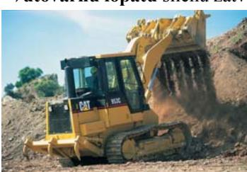
potrebi → **rijač (riper)** (slika lijevo ←). Rabi se za iskop i utovar te po potrebi prijenos (slika desno →), razastiranje i grubo planiranje sipkih zemljanih i kamenih gradiva. On je također →**univerzalni gradevinski stroj** prikladan za izvedbu raznih vrsta zemljanih radova . →**detaljnije vidi** <http://www.fiatkobelco.com> [http://www.zepelin.de/D/lieferprogramm/02laden/6\\_cat\\_ketten.html](http://www.zepelin.de/D/lieferprogramm/02laden/6_cat_ketten.html) ;
