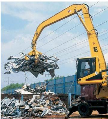
zahvatnom lopatom moguć je samo u uspravnom smislu odnosno lopata se spušta i odiže po okomici. Logistika otvaranja i zatvaranja zahvatne lopate kod →**bagera sajlaša** podržana je mehnizimima užadi a kod →**hidrauličnih bagera** također hidrauličnim
