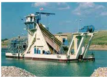
Postoji različite vrste i oblici plovnih bagera u smislu njihove veličine, snage i učinka, načina plovljenja te posebice konstrukcijske logistike rada opreme za iskop pod vodom i odvajanje vode nakon iskopa.
