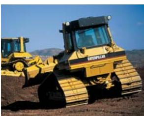
gradilišnih —**damperi** tj. **minidamperi**) te složenih strojeva i postrojenja (→glodalice, →finišeri, →pokretne drobilane itd.) za olakšano kretanje po svom vrstama podloga posebice slabonosivih, kliskih i neravnih terena. Daju također naziv nekim vrstama strojeva ( →utovarivač **gusjeničar**, bager gusjeničar i sl.). Omogućavaju sporo kretanje a time veliku snagu prilikom iskopa primjerice kod kretanja dozera ili
