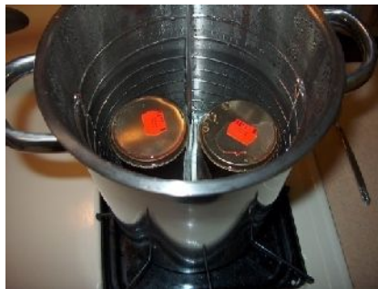
Slika 15c. Sterilizacija materijala u Kohovom loncu
