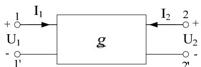
$$\begin{bmatrix} I_1 \\ U_2 \end{bmatrix} = \begin{bmatrix} g_{11} & g_{12} \\ g_{21} & g_{22} \end{bmatrix} \begin{bmatrix} U_1 \\ I_2 \end{bmatrix}$$
