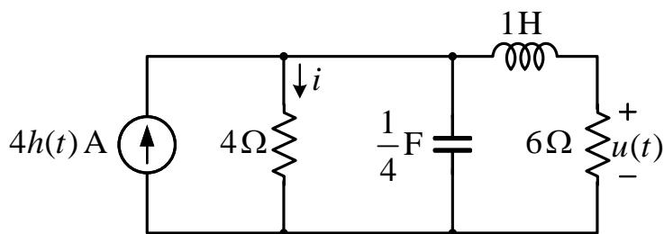
U kolu prikazanom na slici odrediti vrijednost napona  $u(t) = ?$  za  $t > 0$  primjenom klasične metode (rješavanjem kola u vremenskom domenu).
