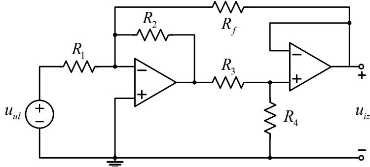
Za kolo prikazano na slici odrediti odnos izlaznog i ulaznog napona:  $u_{iz}/u_{ul}$ .
