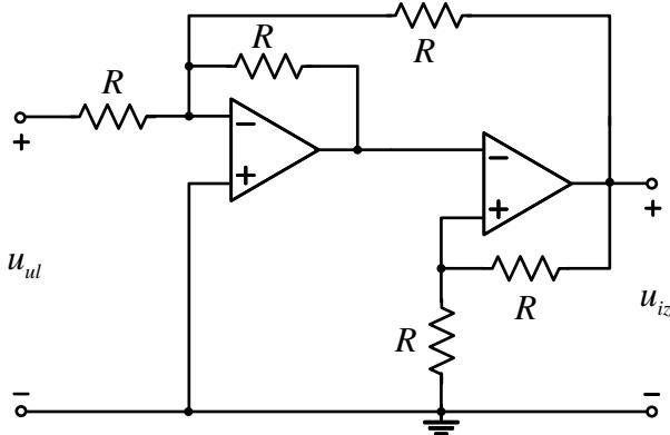
Za kolo prikazano na slici odrediti odnos izlaznog i ulaznog napona:  $u_{iz}/u_{ul}$  ako je  $R = 10 \text{ k}\Omega$ .
