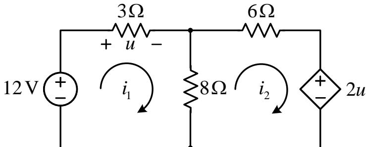
Za kolo prikazano na slici, primjenom metoda nezavisnih napona (nezavisni naponi su određeni osnovnim presjecima) odrediti vrijednosti struja  $i_1$  i  $i_2$ .
