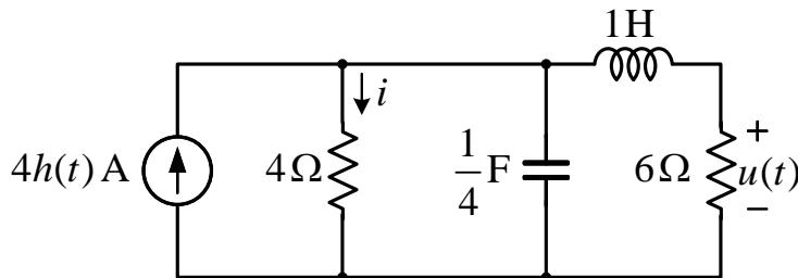
U kolu prikazanom na slici odrediti vrijednost struje  $i(t) = ?$  za  $t > 0$  primjenom klasične metode (rješavanjem kola u vremenskom domenu).
