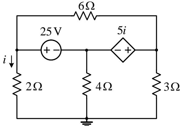
Za kolo prikazano na slici, primjenom metoda nezavisnih napona (nezavisni naponi su određeni osnovnim presjecima) odrediti vrijednost struje  $i$ .
