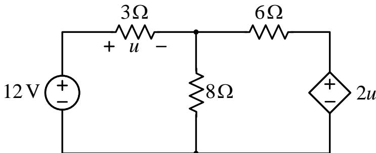
Za kolo prikazano na slici, primjenom metoda nezavisnih struja (nezavisne struje su određene osnovnim konturama) odrediti vrijednost napona  $u$ .
