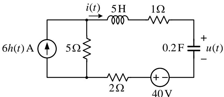
U kolu prikazanom na slici odrediti vrijednost napona  $u(t) = ?$  za  $t > 0$  primjenom klasične metode (rješavanjem kola u vremenskom domenu).
