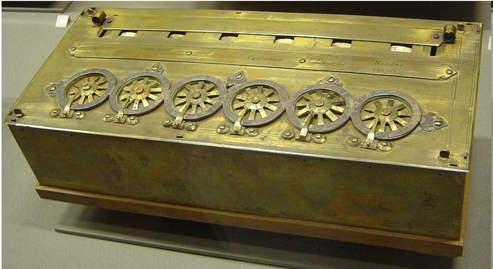
Pascal-ova mehanička mašina za sabiranje i oduzimanje
