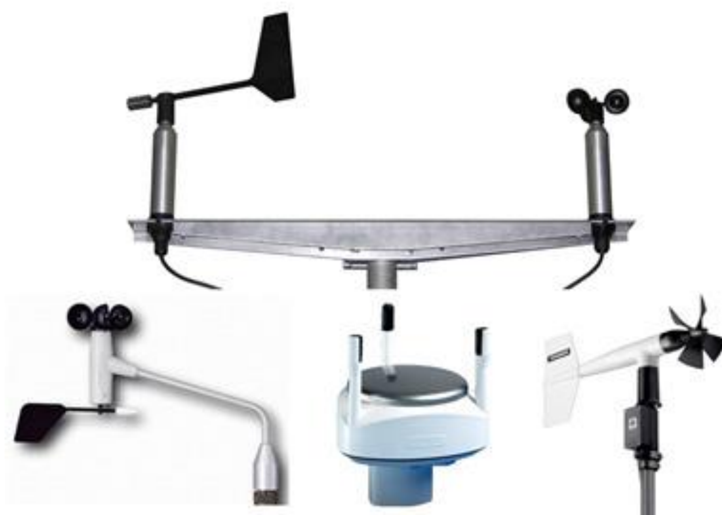
Različiti senzori za mjerenje vjetra (sa propelerima - desno), kopicama, I ultra-sonični senzori (srednji u donjem redu)
